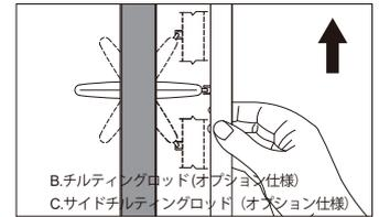
STEP2 A. センターオープンしたい場合、右図矢印の箇所を掴んでいただき、左のパネルを左側に納まり、右のパネルを右側に納まりください。
