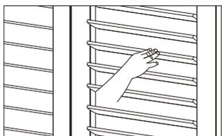
**STEP2** 右図のように右手でパネル同士のスタイルを掴んだら、左手で少しバランスよく左のスタイルを支えて、壁面に収まるようにパネルを右方向に押ししてください。
