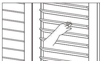
**STEP2** 右図のように右手でパネル同士のスタイルを掴んだら、左手で少しバランスよく左のスタイルを支えて、室内側に引っ張ってください。パネルは一気に引かず、水平でない状態で畳んでください。
