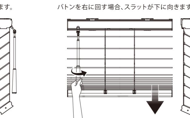
※ コードレスタイプは、調光時、下部のスラットとボトムレールが一緒に回転することで、各スラットがより密着するようになります。調光時、下部スラットと重なるようにボトムレールが巻き上がり傾斜が発生しますが、これは弊社の製品設計による正常な特性です。
