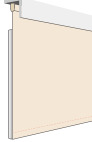
カーテンボックス付け (カーテンボックス内に取り付ける場合)
