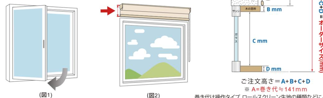
巻き代は操作タイプ、ロールスクリーン生地の種類などにより変わります。最大寸法141mmになります。
