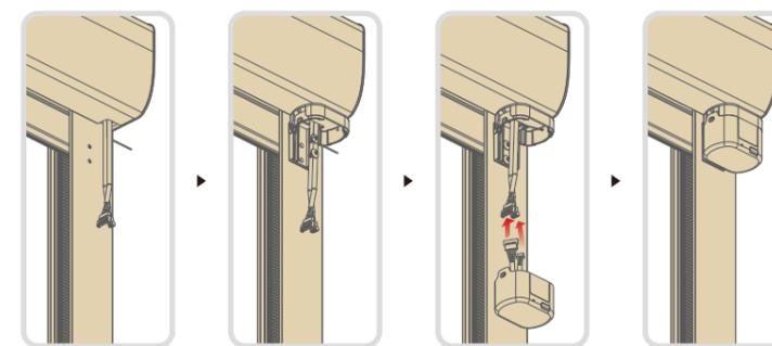
⚠ 警告 必ず本体をブラケットに設置してから電源起動手順を行ってください。
