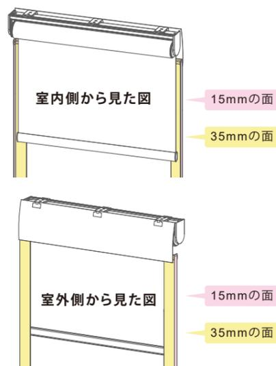
**注意** ネジは設置面に対し垂直に締めてください。ネジが斜めに固定されるとネジ頭が枠内に突出し、生地の昇降を妨げ、製品が破損する恐れがあります。
