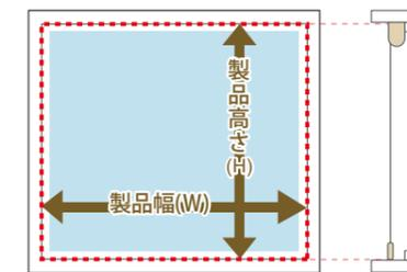
製品幅 窓枠の内側寸法を両端から測定
