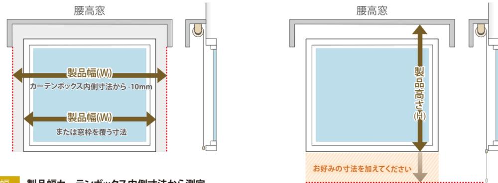
製品幅 製品幅カーテンボックス内側寸法から測定
