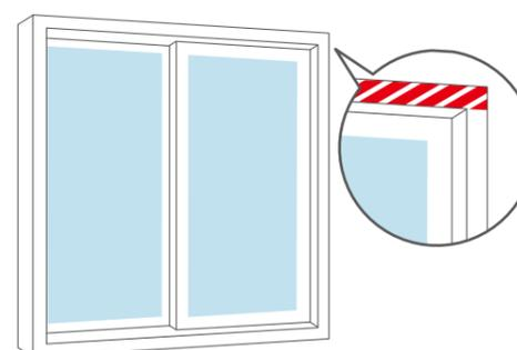
ネジを打ち込むため、窓枠の内側の材質が木材でできていること(金属では打ち込めず、石膏ボードでは十分な強度がありません)
