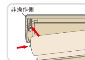
③ 図の通り、マイナスドライバーなどで矢印の方向にツマミを下ろしロック状態にします。
