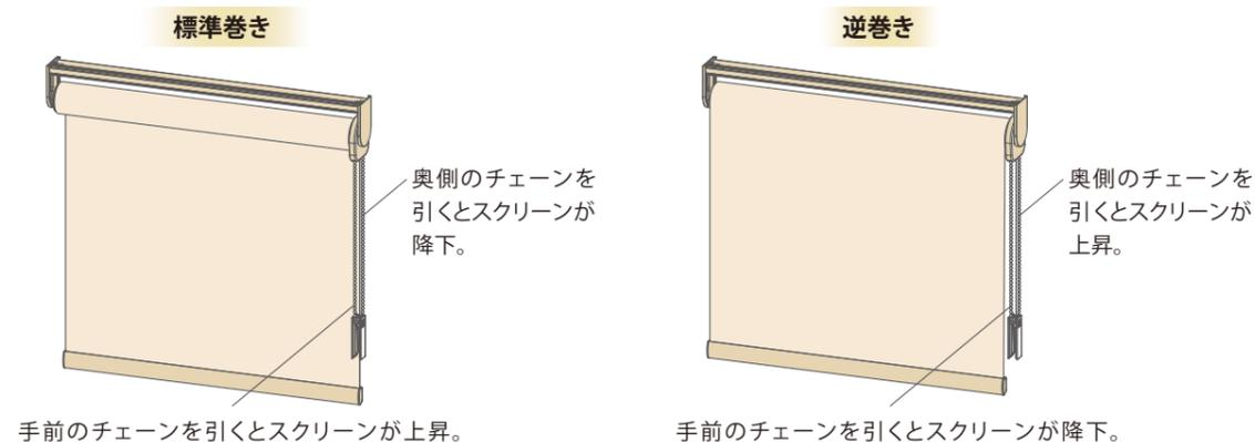
※ チェーンタッチタイプの場合降下チェーンを40mm引くと、スクリーンが自動的に降下します。降下中に上昇チェーンを引くと降下が止まります。降下チェーンを引いても自動降下しない場合、先に上昇チェーンを引いた後に降下チェーンを引くと降下します。
