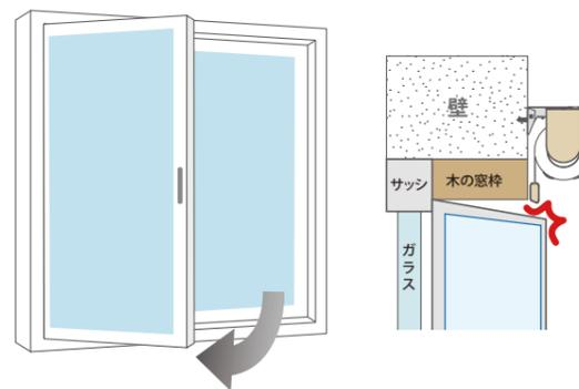
■ 内開き仕様の窓・網戸がある場合、窓・網戸の開閉に支障がないよう、量代計算・採寸・取り付けなど十分ご注意ください。
