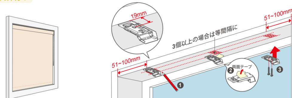
※ ブラケットの設置ネジ穴は、窓枠前面からネジ穴まで19mm以上の間隔が必要です。
