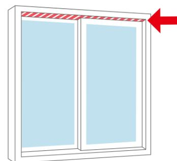
ネジを打ち込むため、窓枠の内側の材質が木材でできていること(金属では打ち込めず、石膏ボードでは十分な強度がありません)。
