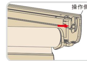
② ①状態のまま、もう一方のパイプをサイドキャップに固定します。非操作側のパイプ中心はバネ式で押すとへこみますので、中心を押しながらサイドキャップにはめ込んでください。パイプがサイドキャップに仮固定された状態です。
