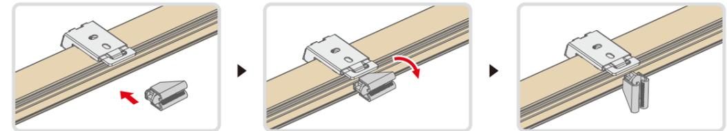
バランス固定ハンガーの設置位置は図のように両端から76~152mm、中間のハンガーは両端と等間隔になるようにしてください。
