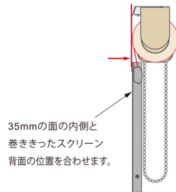
35mmの面の内側と巻ききったスクリーン背面の位置を合わせます。
