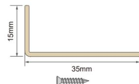
35mmの面の内側と巻ききったスクリーン背面の位置を合わせます。
