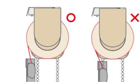
**注意** サイドフレームを設置する際、35mmの面が巻き取りパイプに近づけすぎないようにご注意ください。生地背面と遮光サイドフレームが干渉してしまう恐れがあり、生地に干渉してしまうと、破れや操作不良の原因となることがあります。
