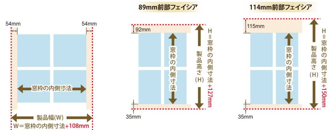
製品幅 窓枠の内側寸法108mm(54mm+54mm)を足してください。
