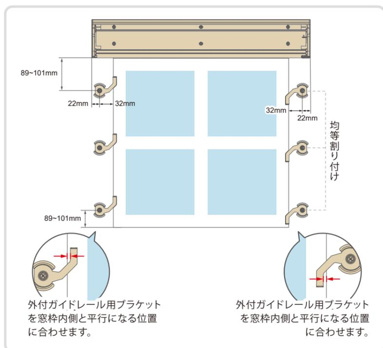
7-5 ボトムチャンネルの取り付け ※ オプション:窓枠天井付けのみ、ボトムチャンネル無しの場合は省略
