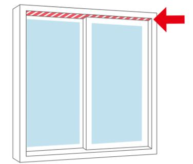
ネジを打ち込むため、窓枠の内側の材質が木材でできていること(金属では打ち込めず、石膏ボードでは十分な強度がありません)。
