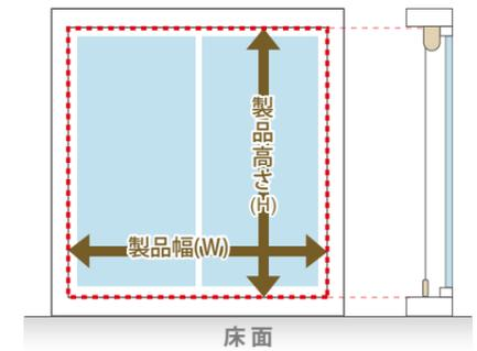
製品幅 窓枠の内側寸法を両端から測定
