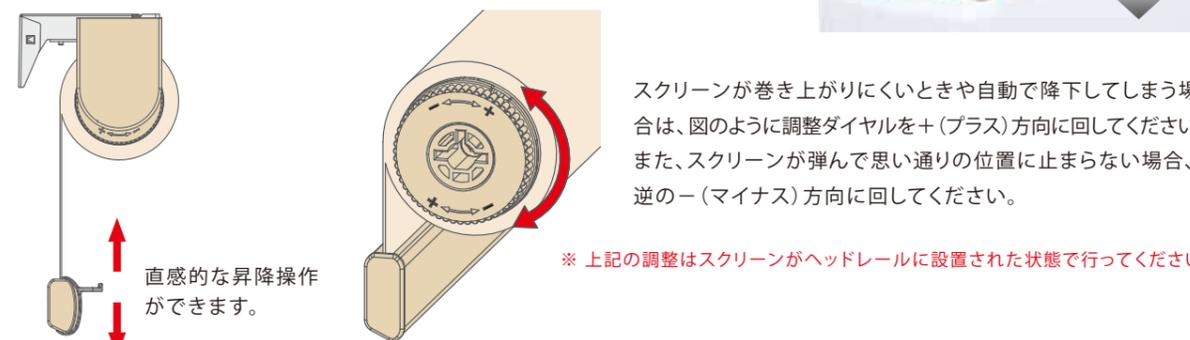
スクリーンが巻き上がりにくいときや自動で降下してしまう場合は、図のように調整ダイヤルを+ (プラス) 方向に回してください。また、スクリーンが弾んで思い通りの位置に止まらない場合、逆の- (マイナス) 方向に回してください。
