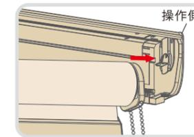
② ①状態のまま、もう一方のパイプをサイドキャップに固定します。非操作側のパイプ中心はバネ式で押しとへこみますので、中心を押しながらサイドキャップにはめ込んでください。パイプがサイドキャップに仮固定された状態です。
