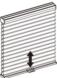
付属のグリップを確実に装着のうえ、操作時はレールの水平を保ちながら、急激な昇降操作は避けてください。またグリップの数は製品幅に応じて異なります。
