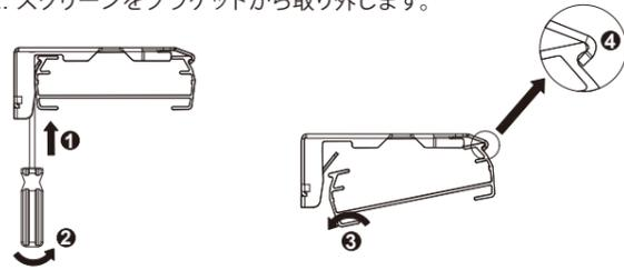
**警告** 製品本体を取り付けるときは、本体がブラケットにしっかり固定されているかを必ず確認してください。取付が不完全ですと製品が落下して、ケガや周辺物破損の原因となる恐れがあります。
