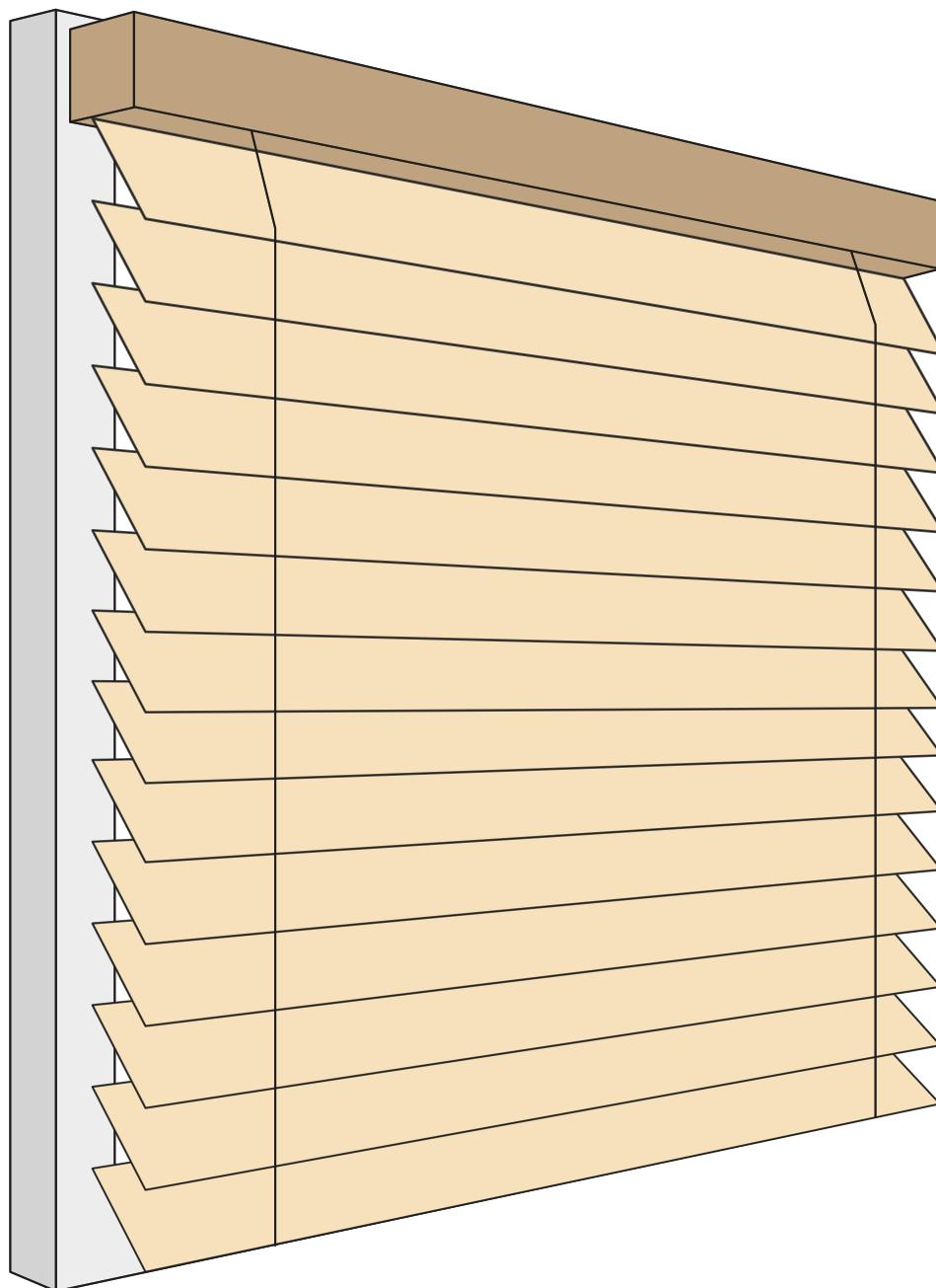
窓枠正面に取り付ける時
