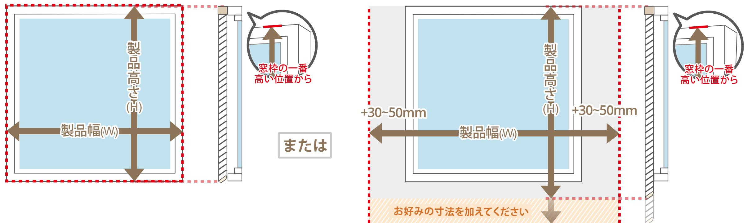
製品幅は窓枠の外側寸法を測ってください。
