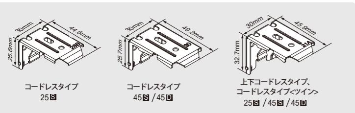
■窓枠天井付け(鴨居付け)・浅天井付け・窓枠正面付け・カーテンボックス付け-ブラケット、グリップ、仮止め用両面テープ、19mmネジ鴨居付け以外用、31mmネジ鴨居付け
