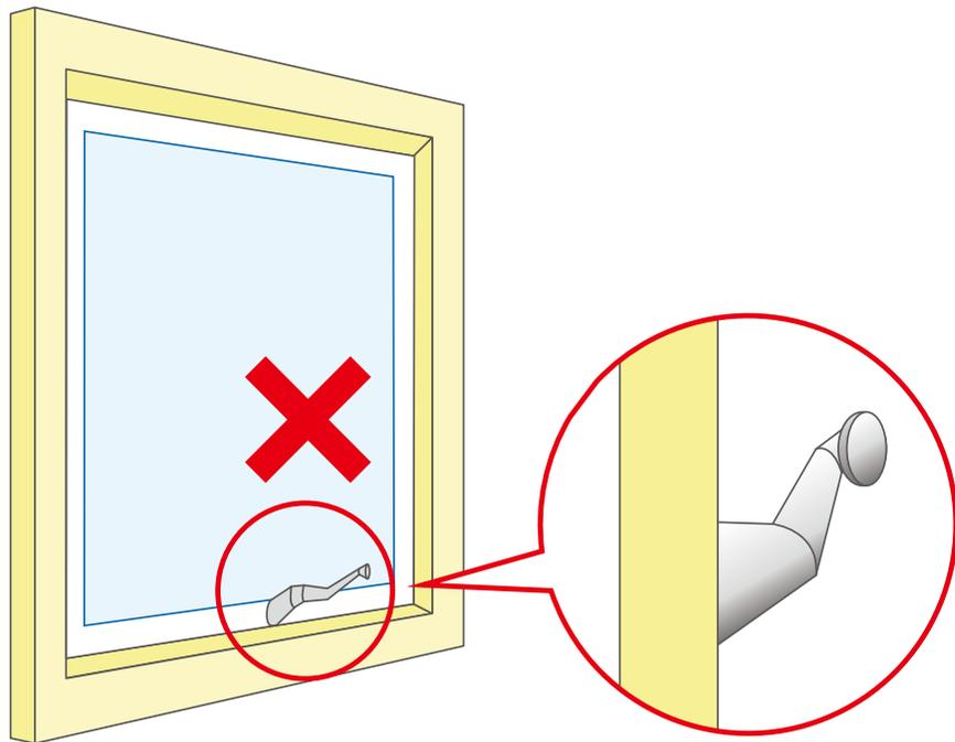
外に突出した取っ手などがある場合は、ブラインドの昇降を妨げます。取っ手が窓枠から突出するかどうかをご確認ください。
