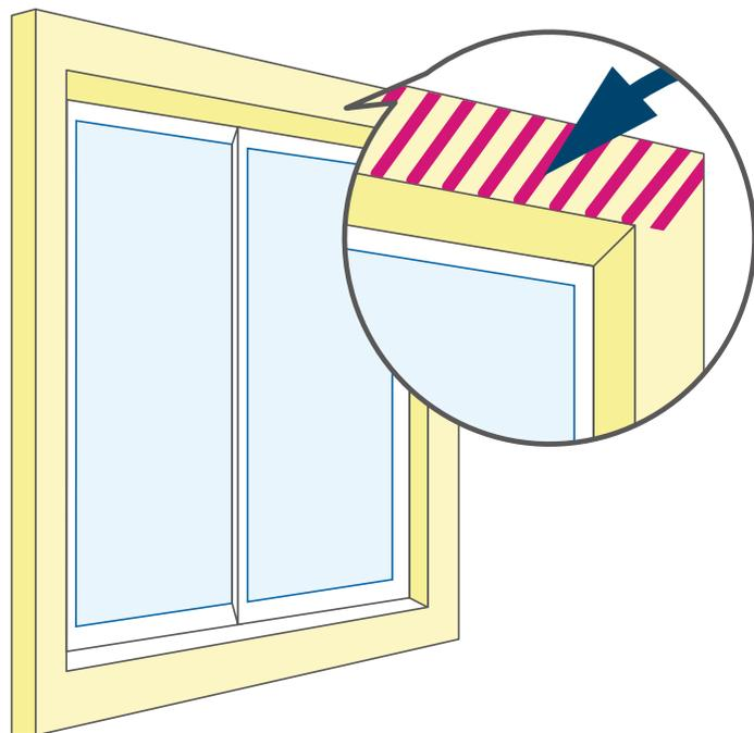
ネジを打ち込むため、窓枠の内側の材質が木材でできていること
