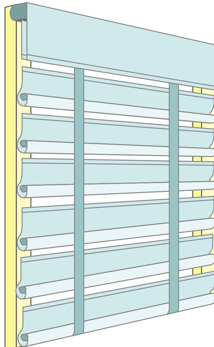
窓枠正面に取り付ける時
