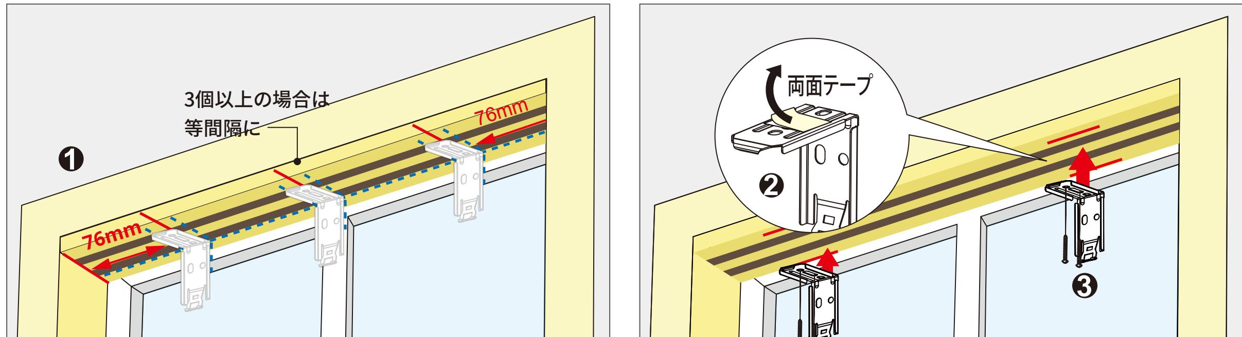
1. ブラケットが平面位置（左図参照）に接することを確認し、ネジを凹み箇所に差し込み固定します。
