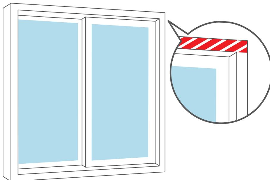
ネジを打ち込むため、窓枠の内側の材質が木材でできていること。
