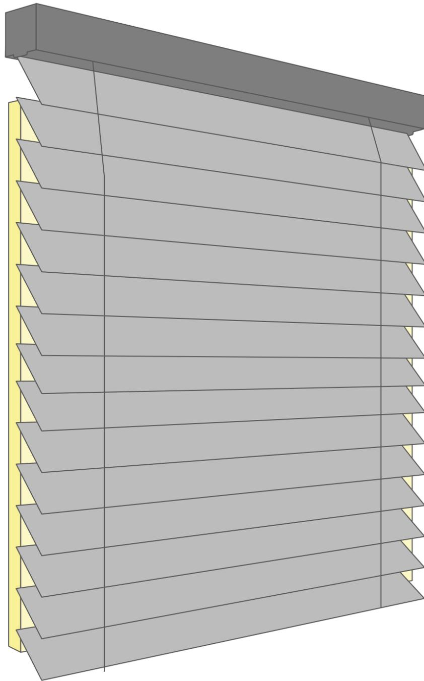
窓枠の上の壁面に取り付ける場合
